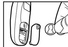
Retirez le volet de la pile avec un tournevis ou une pièce
